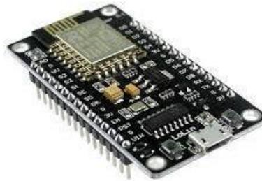
Gambar 2.1 Bentuk fisik NodeMCU ESP8266
