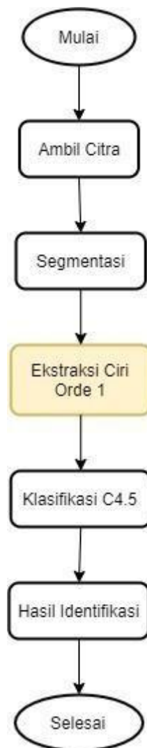
Gambar 4.2. Diagram Alir Sistem Identifikasi dengan Ekstraksi Orde 1
