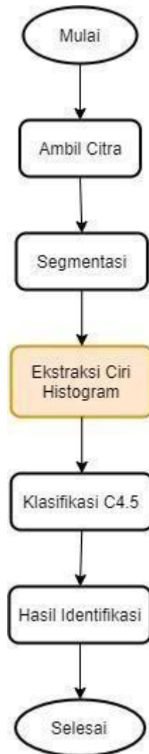
Gambar 4.3 Diagram Alir Sistem Identifikasi dengan Ekstraksi Ciri Histogram
