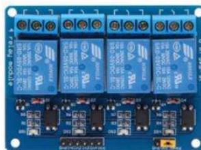
Gambar 2.7 Relay Module
