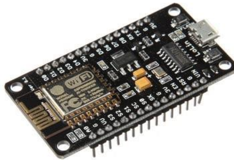
Gambar 2.2. ESP 8266 NODEMCU V3
