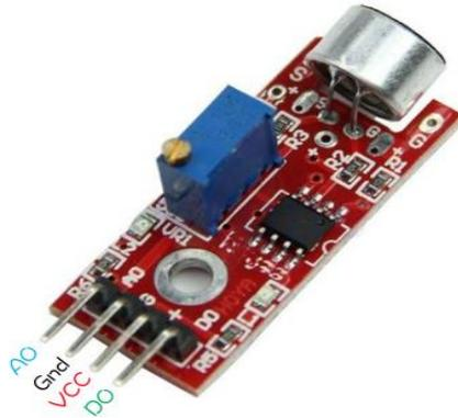
**Gambar 2.5 Modul Sensor Suara dan Skema Pin**
