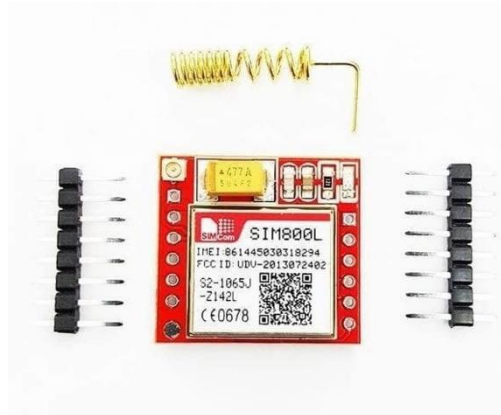
Gambar 2.3 Modul GSM SIM 800L
