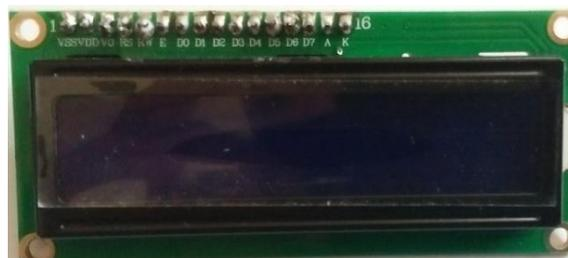
Gambar 2.8. LCD 16x2 I2C Tampak Depan
