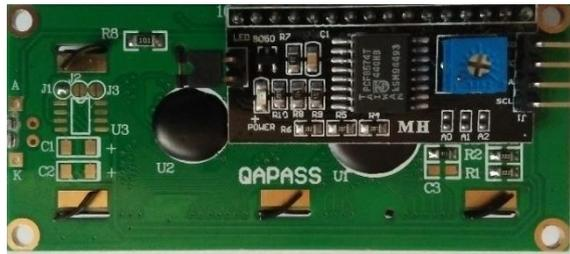
Gambar 2.9. LCD 16x2 I2C Tampak Belakang
