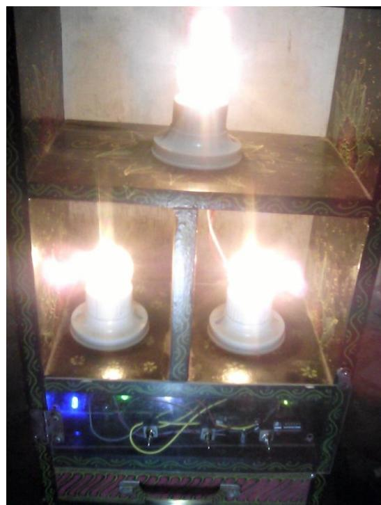
Pada rangkaian, lampu dalam keadaan hidup. Lampu pertama menyala secara berkedip, lampu kedua menyala dari redup ke terang, dan lampu ketiga menyala dari terang ke redup.
