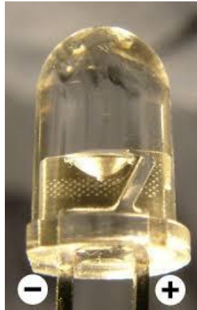
Gambar 2.6 Kutup Positif dan Negatif Lampu Led
