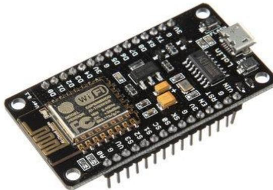
**Gambar 2.3.1 NodeMCU V3**
