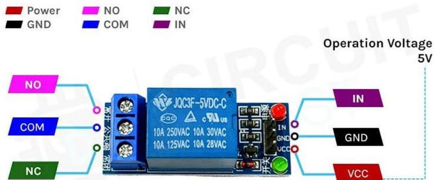
Gambar 2.5 Modul Relay 5V
