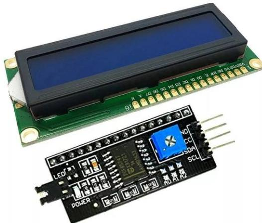
Gambar 2.7 LCD I2C dan Modul I2C
