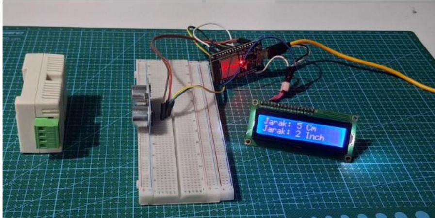
Gambar 2.14 Rangkaian Monitoring Jarak dengan Ultrasonic HC-SR04 pada LCD 16x2 I2C
