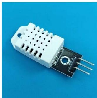
Gambar 2.6 Sensor DHT22
