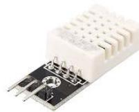
Gambar 2. 2 Sensor DHT22
