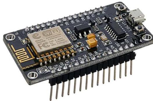
Gambar 2. 2 NodeMCU ESP8266
