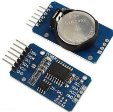
Gambar 2.10. Modul RTC DS3231
